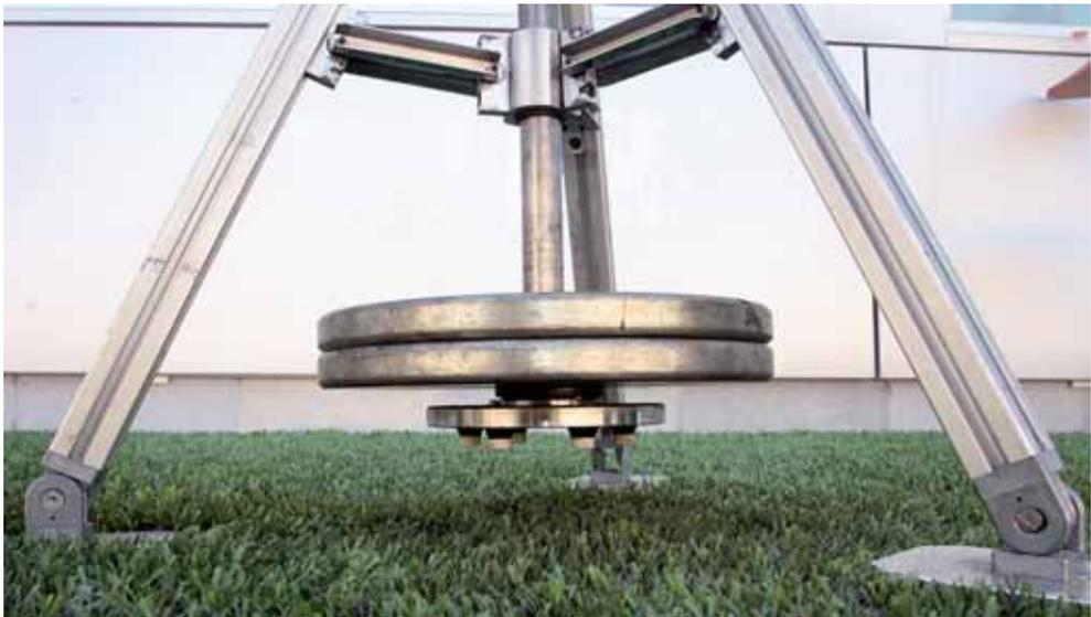
Figura 14. Equipo de evaluación de la tracción rotacional
