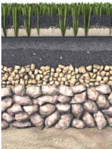
**Figura 11.** Ejemplo de solución constructiva para un campo de fútbol de césped artificial de tercera generación
