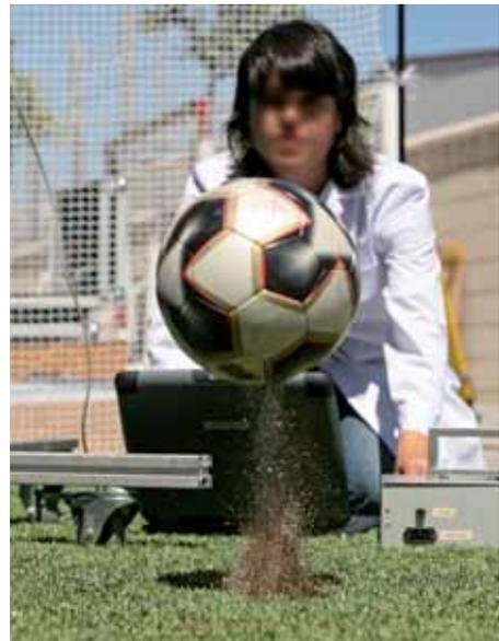
Figura 16. Estructura para la evaluación del bote vertical de balón
