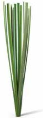
Figura 7. Fibra recta-monofilamento
