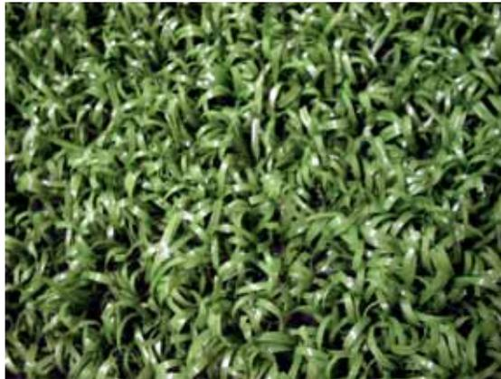
Figura 9. Moqueta de hierba artificial con fibra rizada
